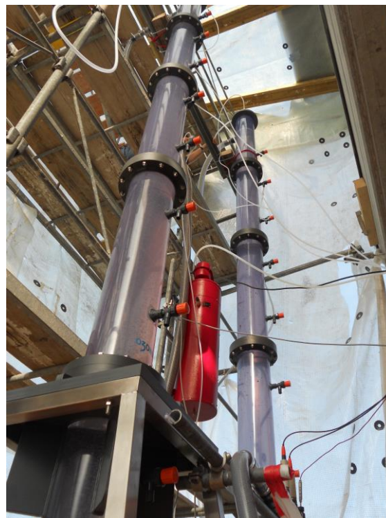
Illustration 4: réacteur d'ozonation (photo: A. Gurtner, Pöyry Suisse SA).
