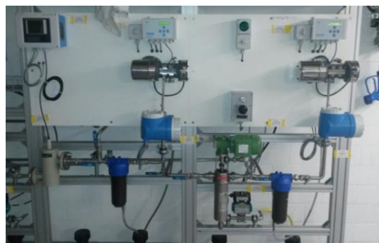
Illustration 3: mesure des UV sur la STEP de Neugut (photo: J. Fleiner).
