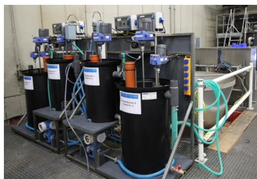
Abbildung 6: Kontaktreaktoren der zwei-straßigen Versuchsanlage des KomS (Bild: KomS).
