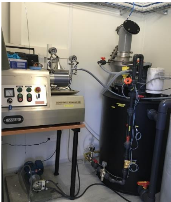
Abb. 2 : Mahlgerät und Behälter mit der PAK-Suspension
