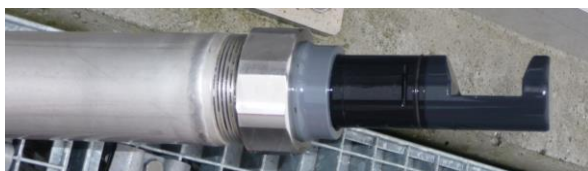
Abbildung 3. Nahaufnahme eines Messspalts einer SAK-Sonde (Foto: ARA Reinach)
