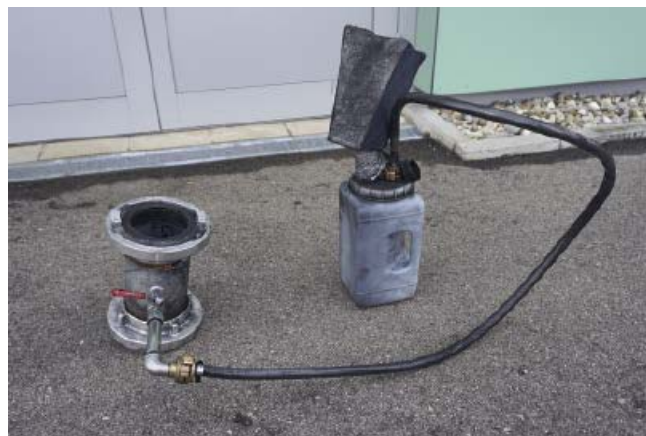
Abb. 8: Probenahmemöglichkeit für ein Rückstellmuster während der Befüllung des PAK-Silos vom Typ Eigenbau
