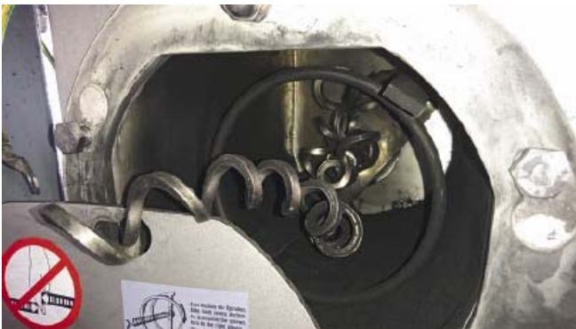
Abb. 5: Durch Fremdstoffe zerstörte Dosierschnecke
