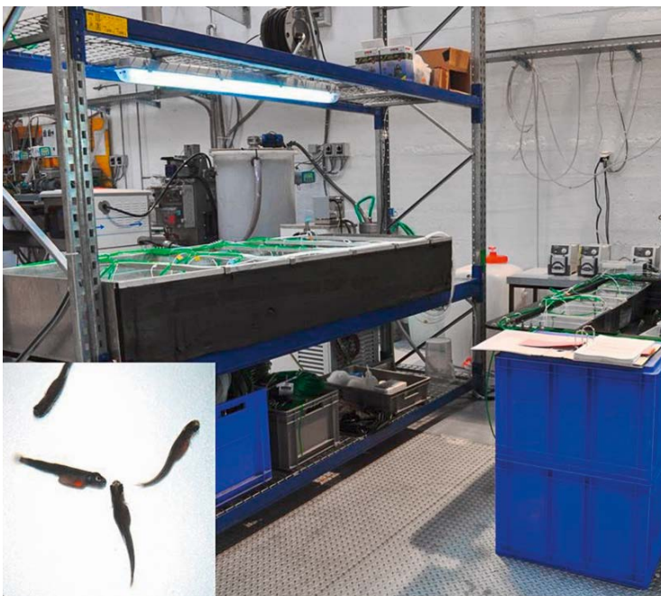
Fig. 3 Aufbau des Fischtest in der Versuchshalle der ARA Neugut. Das kleine Bild (unten links) zeigt junge Regenbogenforellen mit Dottersack.
